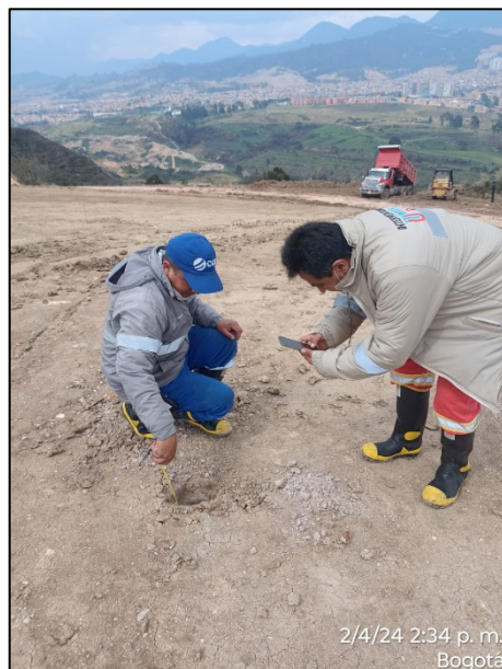
Fotografía 183. Prueba in situ de verificación de espesores de capa de arcilla en Zona II – Área 3.
