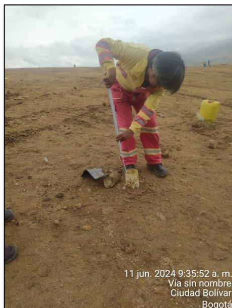
Fotografía 185. Ensayos de permeabilidad in situ en Zona II - Área 3
