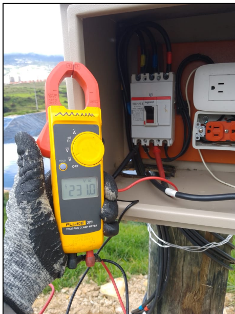
Fotografía 111. Pruebas de funcionamiento y medición de carga a los circuitos de iluminación del relleno sanitario
