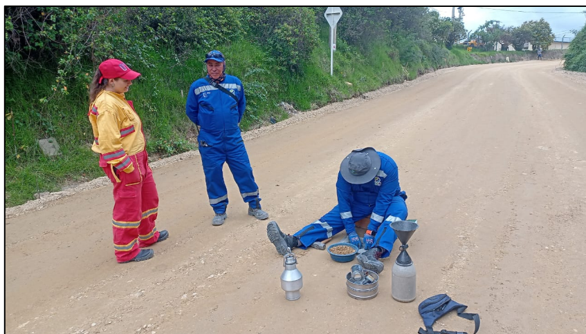
Fotografía 57. Toma de densidades para liberación de base granular entre las abscisas K2+315 y K2+470
