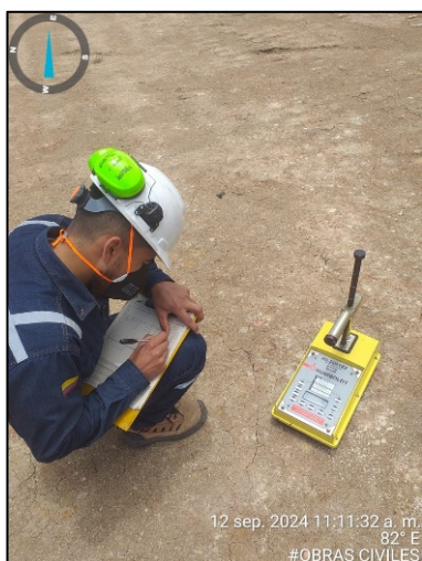
Fotografía 188. Toma de densidades de compactación de la capa de arcilla en Zona II – Área 3
