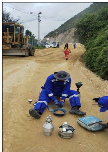
Fotografía 57. Toma de densidades para liberación de base granular entre las abscisas K2+315 y K2+470
