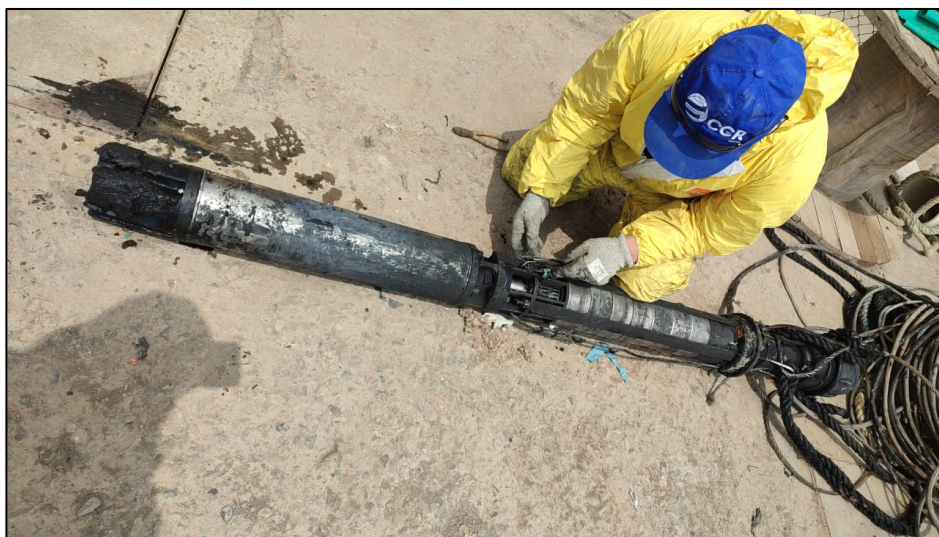
Fotografía 130. Mantenimiento y limpieza de bomba sumergible marca Franklin Electric de 20 hp
