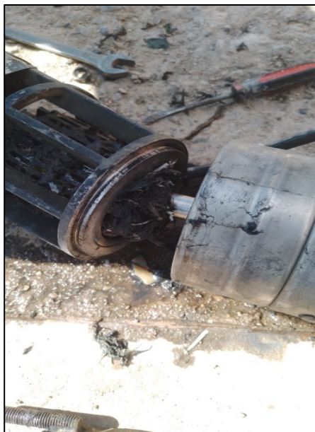
Fotografía 131. Mantenimiento y limpieza de bomba sumergible marca Franklin Electric 7.5 hp – Pozo lateral de terraza 2
