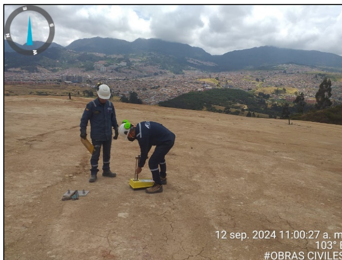
Fotografía 188. Toma de densidades de compactación de la capa de arcilla en Zona II – Área 3
