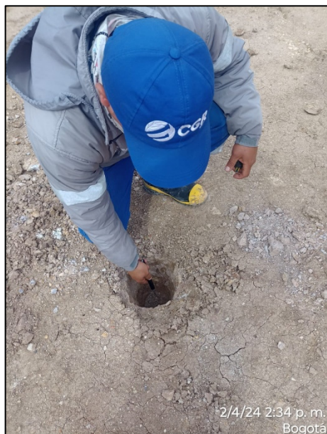
Fotografía 183. Prueba in situ de verificación de espesores de capa de arcilla en Zona II – Área 3.
