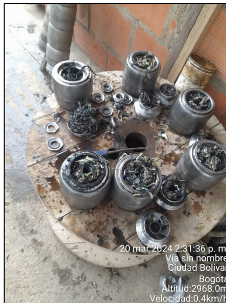
Fotografía 133. Mantenimiento y limpieza de bomba sumergible marca Franklin Electric de 20 hp – CHP 1075
